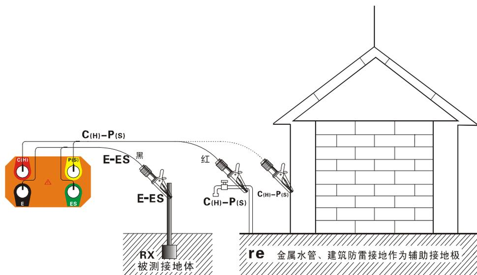
简易法测量接地电阻，其仪表读数为被测接地体的接地电阻值与商用接地体的接地电阻值之和，即： $R = R_X + r_e$
