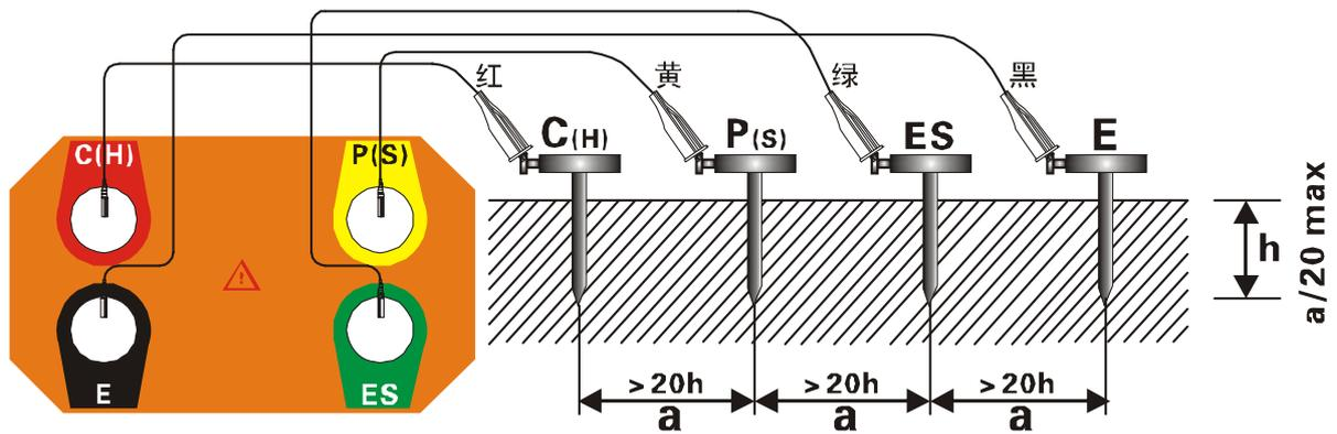
根据温纳法确定测量土壤电阻率的值约为两个接地棒间的距离  $a$  深度处的土壤电阻率,可通过改变  $a$  值来检查土壤均质性,从而设计合适的接地电极。
