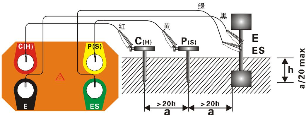
对于多点独立接地系统或大地网接地系统，用户自行选用更长的测试线即可，电极间距大于被测试地网最大对角线长的 5 倍即可。如下图：
