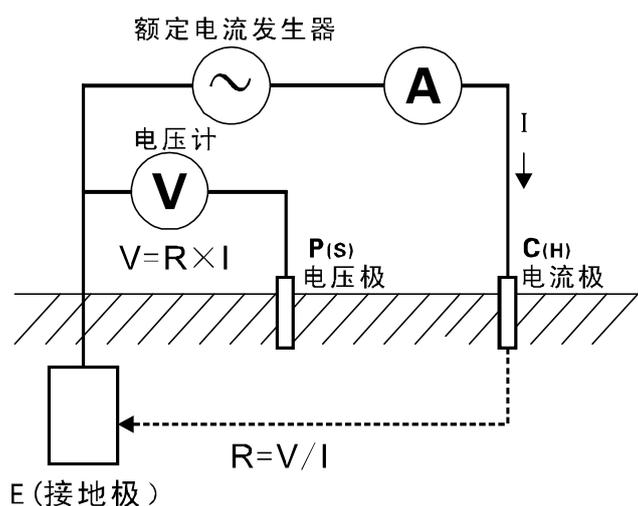
3. 土壤电阻率( $\rho$ )测量采用 4 极法(温纳法): **E** 接地极与 **C(H)** 电流极间流动交流电流  $I$ ，求 **P(S)** 电压极与 **ES** 辅助地极间的电位差  $V$ ，电位差  $V$  除以交流电流  $I$  得到中间两点电阻值  $R$ ，电极间隔距离为  $a(m)$ ，根据公式  $\rho=2\pi aR(\Omega m)$  得出土壤电阻率的值，**C(H)**-**P(S)** 的间距与 **P(S)**-**ES** 的间距相等时(都为  $a$ )即为温纳法。为了计算方便，请让电极间距  $a$  远大于埋设深度  $h$ ，一般应满足  $a>20h$ ，见下图。
